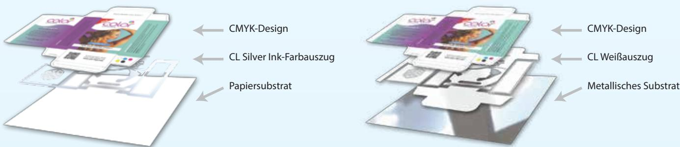
Die Abbildungen oben veranschaulichen die Arbeitsweise des Process Metallic Color Systems auf weißen Substraten mit Silber-Druckfarbe (links) und auf metallischen Substraten mit weißer Druckfarbe (rechts).
